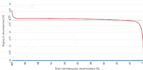
Rys. 9 Spadek napięcia akumulatora, rozładowanie 1C
